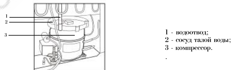
Рисунок Б.2 - Схема отвода талой воды из холодильной камеры.
